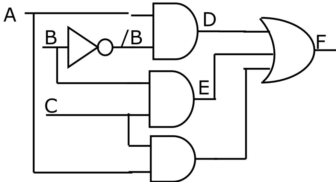
Con esta estructura aunque redundante se evita que ocurra el riesgo de "1" ya que la compuerta adicional evita que el retardo del negador pueda dar una falsa respuesta.
